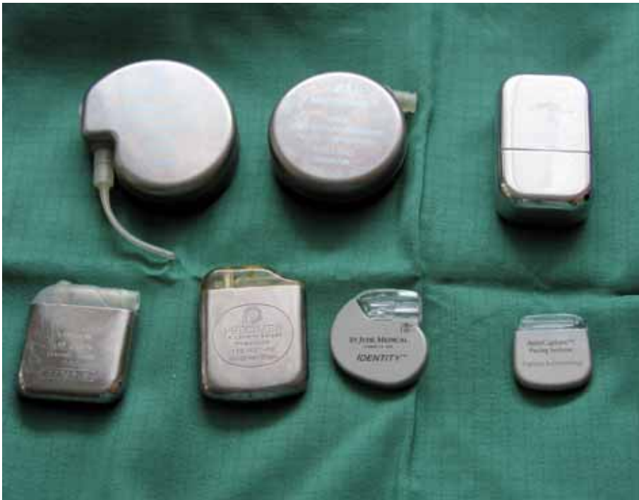
Herzschrittmacher-Modelle aus den 70er-Jahren bis zu den Minigeräten heute.
